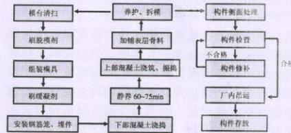
图 7 预制构件生产工艺流程图
